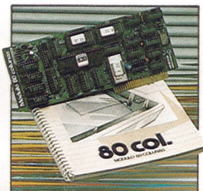
80 colunas: Módulo para mudança do padrão de vídeo para 80 colunas x 24 linhas.
